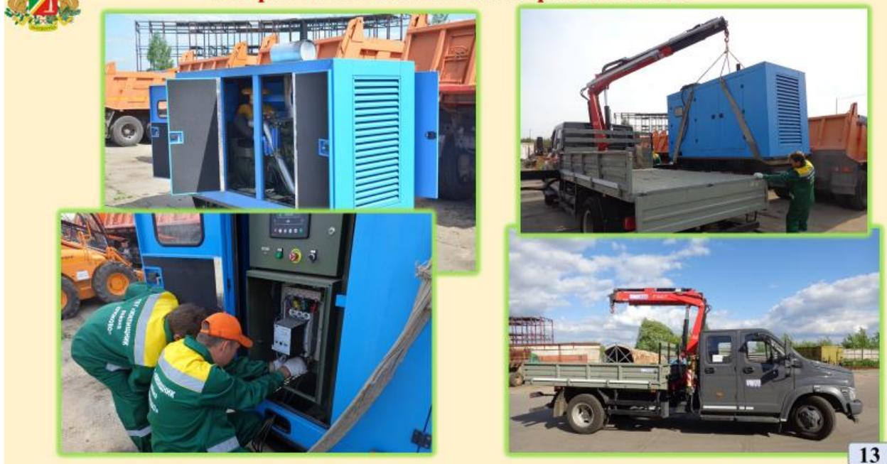
В Жилищнике имеются **2 автономных резервных источника электроснабжения** мощностью до 220 кВт, каждый из них способен запитать жилой корпус на **300 квартир**.
