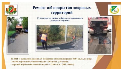
В 2021г. на подведомственной территории ИС Крюково был выполнен текущий ремонт асфальтобетонного покрытия общей площадью 5654 кв. м., на что было израсходовано более 46 тонн литой и 881 тонн горячей асфальтобетонной смеси. Также ИС были закуплены песчаные смеси для выполнения работ по ремонту 43 отмонок и 40 крылец общим метражом около 1000 кв.м и реализованы в полном объеме.
